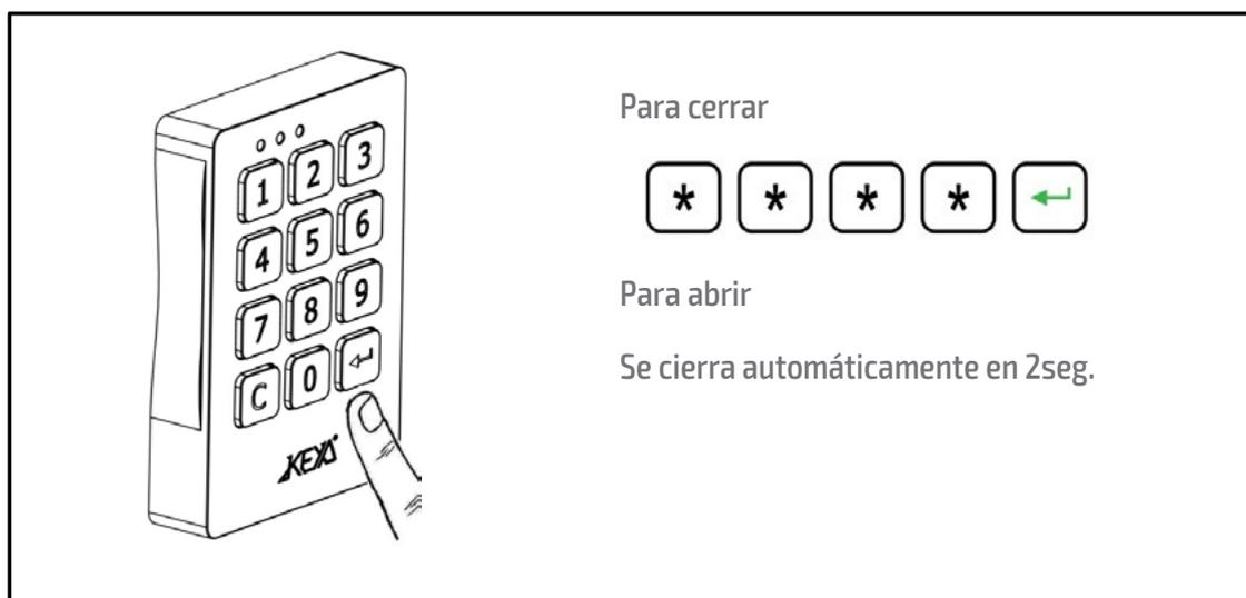
Acceso mediante un código de 4 dígitos. El código está configurado para un solo usuario.
