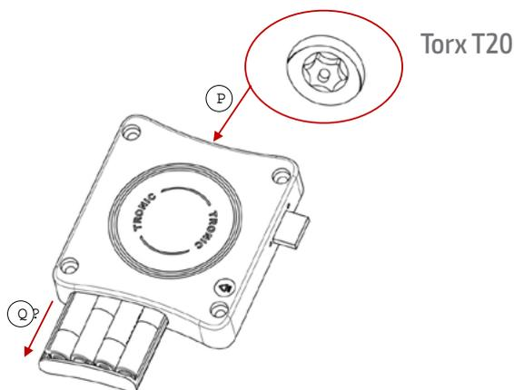
**IMPORTANTE:** El cambio de pilas debe efectuarse en menos de 5 minutos y con el BATPACK en todo momento conectado (de lo contrario el reloj interno perdería la hora).
